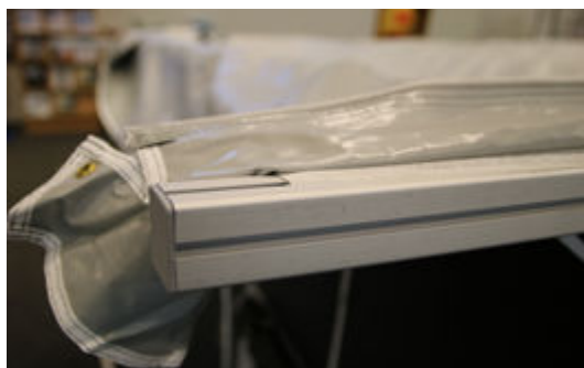
*2 - Trä i baldakinstagen nr 11 i vulster på sidorna på bakväggens överligger.
