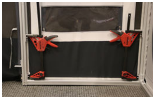
*1 - Spänn upp frontväggen sektionsvis med att sätta tvingarna på övre delen mellan tvärstaket och överliggaren.
